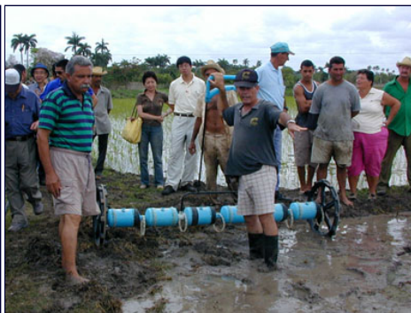
手動播種機による実証試験
