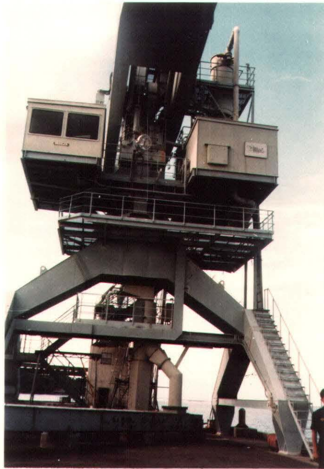
(7) 1985年バタンガスから7km離れたパウアンに 建設されたビューラー製コーンバルクアンローダー (90トン/時)
