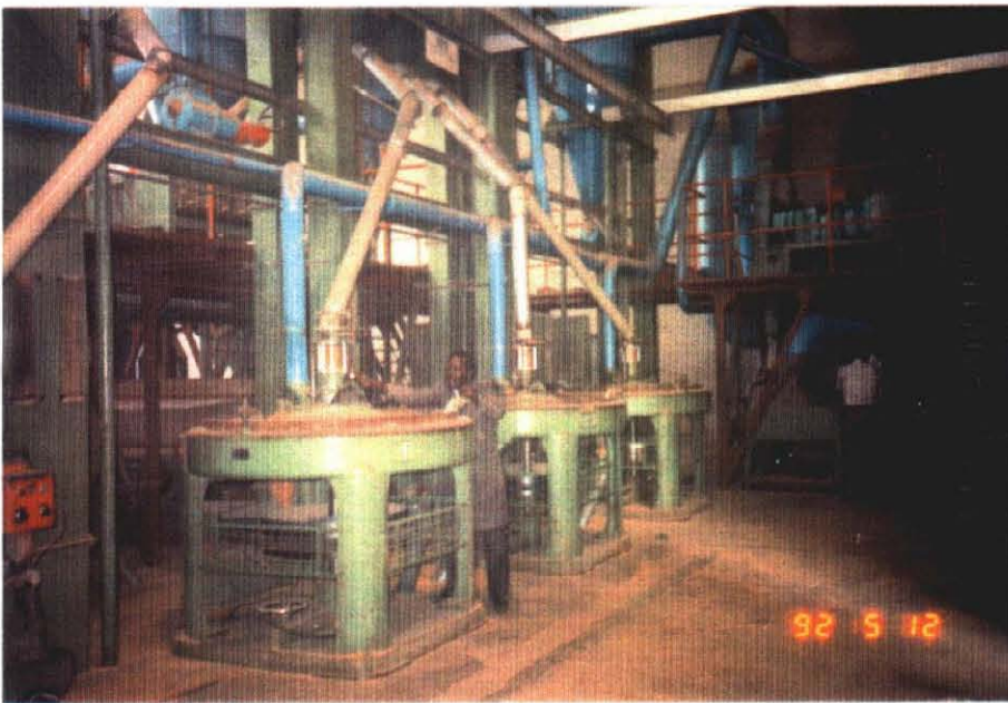
既存精米機 (精米能力：5 tons/hr)
