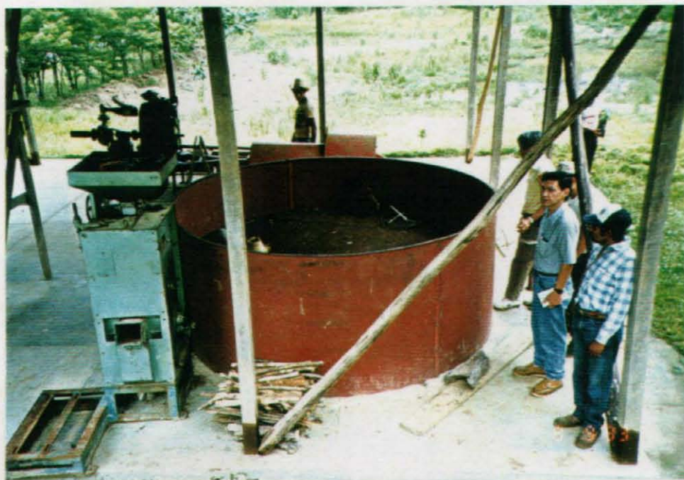
DIGESA にある香料「カルダモン」の乾燥機
