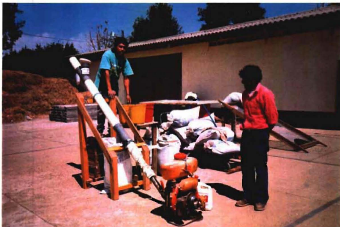
CHIMALTENANGOの試験圃場での種子の選別 (エンジンをを用いて塵を取り除いている)
