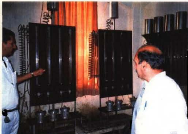
灌漑研究所-アナルカリ 6 土質試験 (透水性試験)
