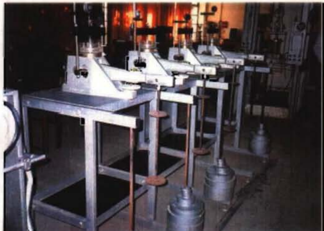
灌漑研究所-アナルカリ 5 土質試験 (圧密試験、三軸圧縮試験)
