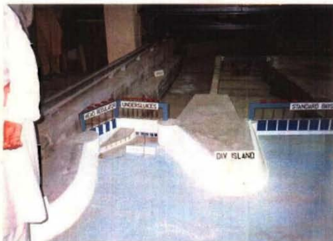
灌漑研究所-アナルカリ 4 室内水理模型実験
