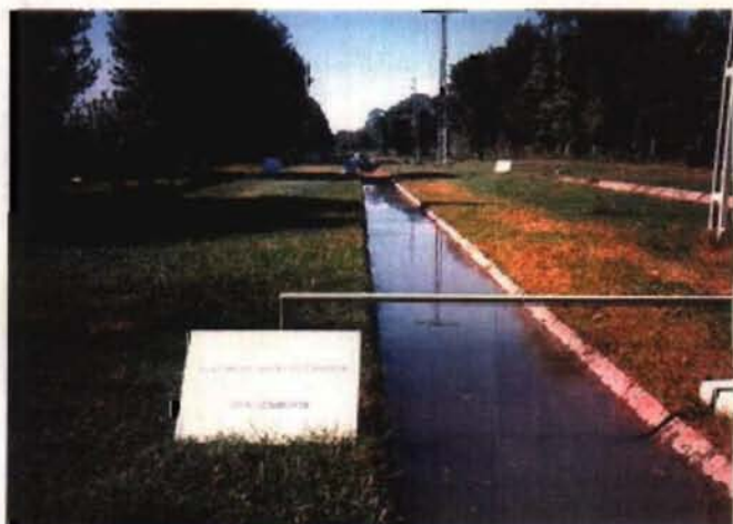
灌漑研究所-ニアズベッグ1 水路の浸透試験
