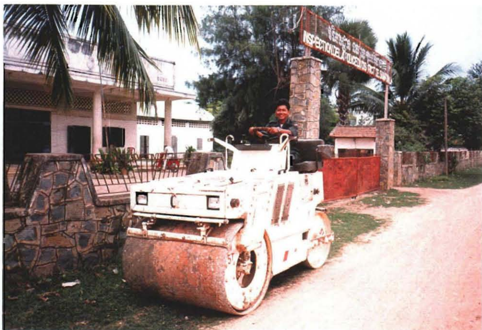
陸上自衛隊が寄贈した転圧機（重量5 t）、 タケオ県サムロン郡で農村道路改修に使用されている。
