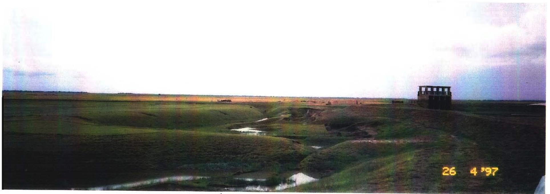
2-3 ルーア・ハル内の農地及び小排水路。建設済みの締め切りゲートを操作して、初期洪水による内水位の上昇を抑制し、洪水末期の重力排水に貢献する。
