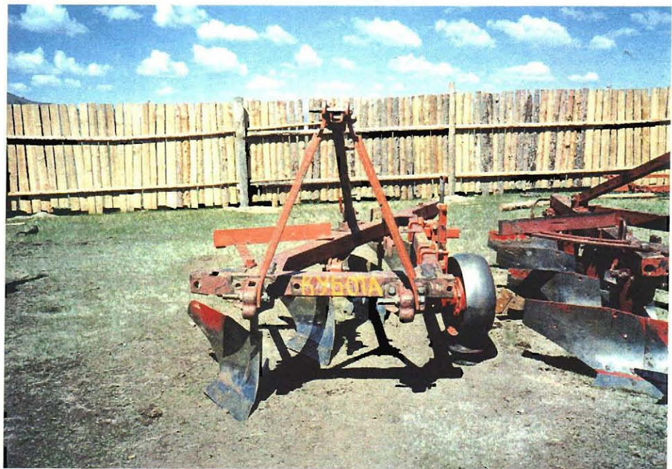
旧ソ連製のプラウを日本製トラクタに装着するため改造したものの。
