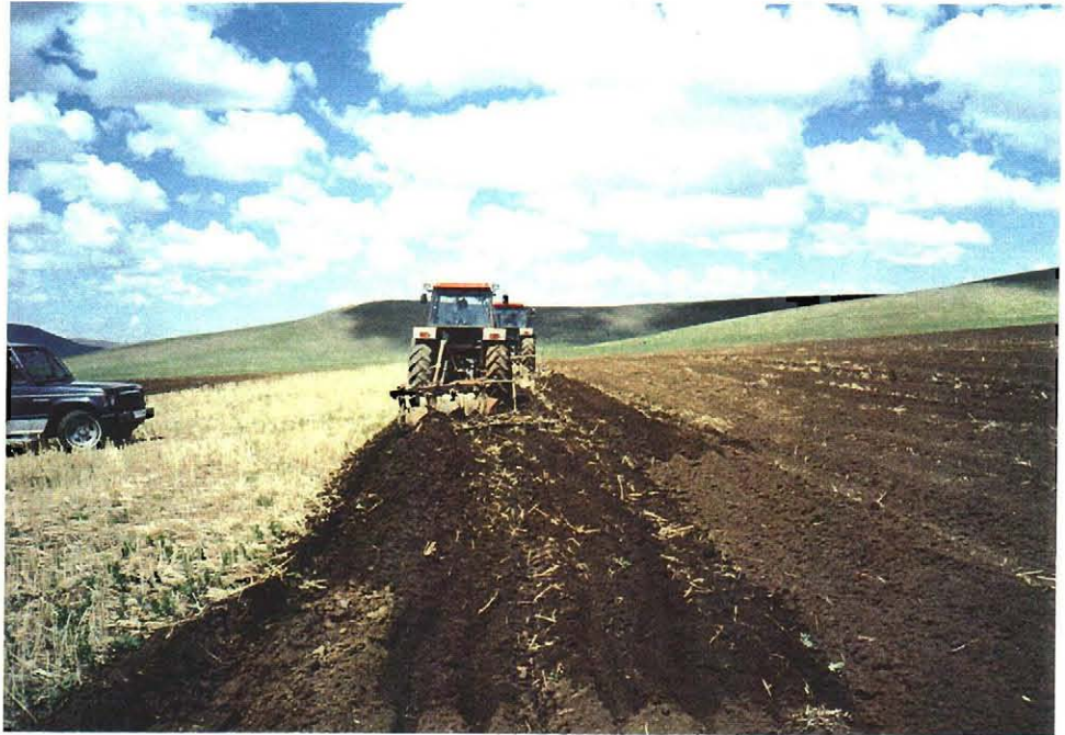
KR-II により供与された日本製トラクタ（於ダルハン） 索引線が出ていないので無理な力がステアリングにかかっている。
