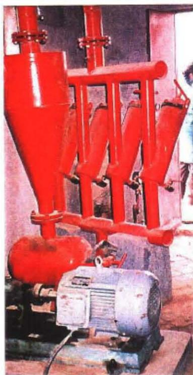
点滴灌漑用水の土砂濾過試験機
