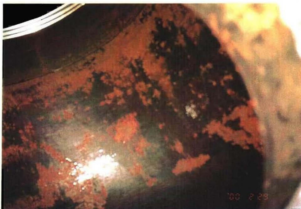
I A A P I S—アムルング機場 No. 4 ポンプのケーシング内面の腐食状況（比較的良好な状況に見える）。
