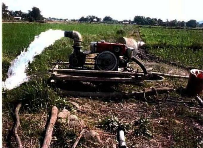
この地域で行われている地下水利用の灌漑施設。農地の脇に井戸を掘り、可搬式小型ポンプ（口径 3"の小型渦巻ポンプと、5～7.5 ps のエンジン）で地下水を汲み上げ、農地を灌漑している。灌漑可能面積はポンプ能力などから判断して最大でも水稲で 3～4 ha 程度と推定される。
