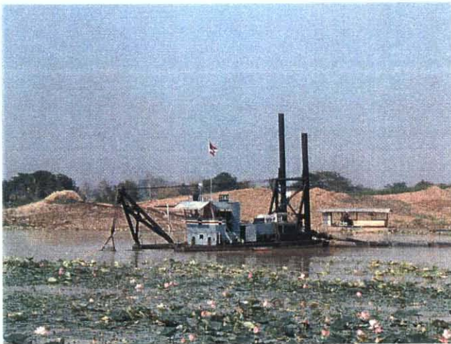
ヨム川右岸の Nong Khun Yai で使用中の浚渫船。年間 250,000 cu.m の浚渫で8年間を予定している。
