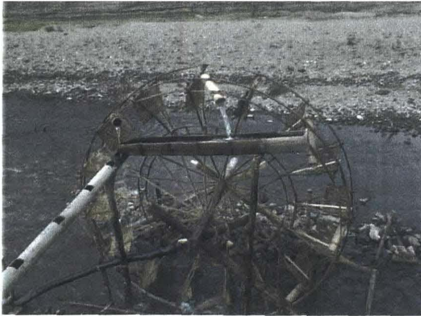
河川に設置された灌漑用水車 (3 m程度の揚水が可能である)
