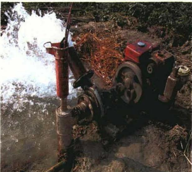
Tube well pump による地下水灌漑 (Bogra) (2)
