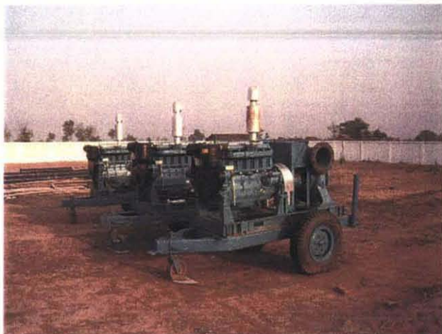
州水資源局に配備された灌漑ポンプ(インド製)
