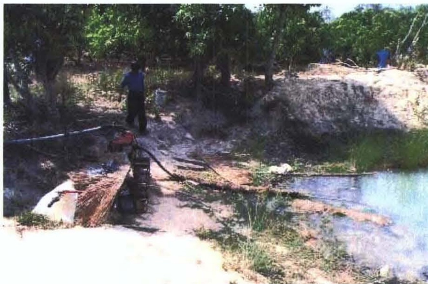
ファームポンドからトラクターのエンジン を利用してポンプアップしている農家
