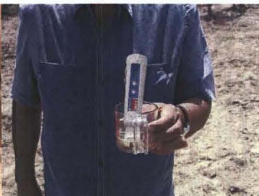
写真-23. 現場での EC 測定状況
