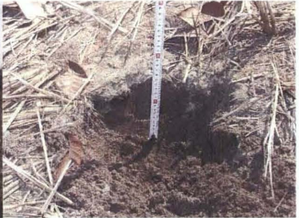
写真—17. 水田の圃場面に堆積した海砂
