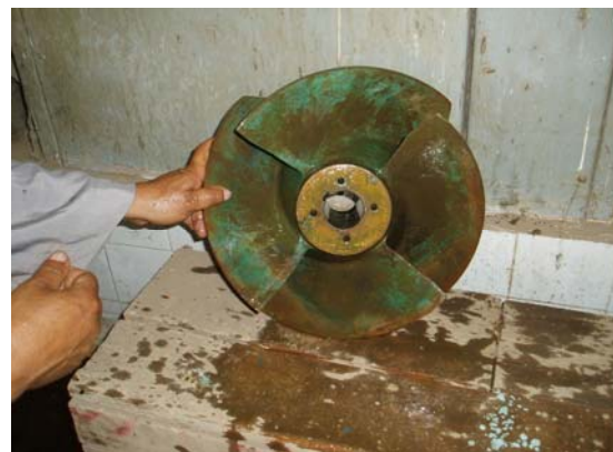
オーバーホール中のポンプインペラー 比較的良好な状態である。
