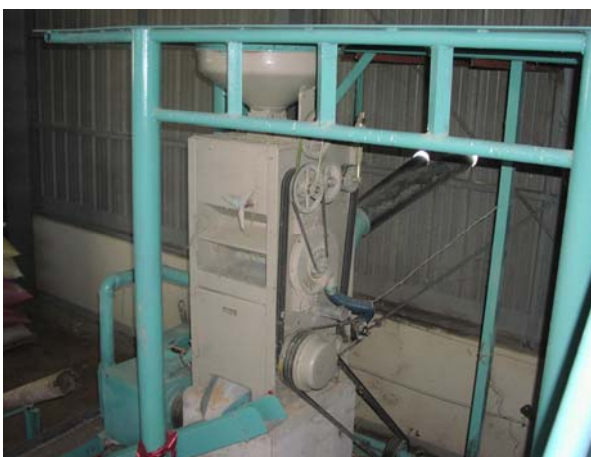
アガナン収穫後処理施設 2007 年 JICA により供与された精米機(1t/hr) 現在ライセンスの問題で使用されていない
