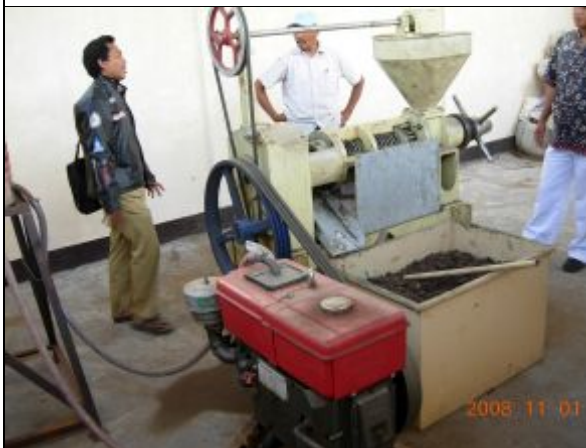
エネルギー・鉱山省が農民グループに供与したインドネシア製のジャトロハ搾油機。手前ボックスは搾油粕の Seed cake
