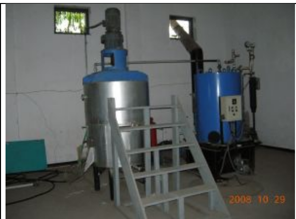
同左の搾油工程前の原料加熱装置。全工程は原料加熱、種子圧搾、フィルターの 3 工程
