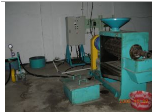
中央ロンボック県 Praya 郡で稼働している PT. Tri Agri 搾油プラント(スエヒロ EPM 製で 1 t 種子/日の搾油処理能力)
