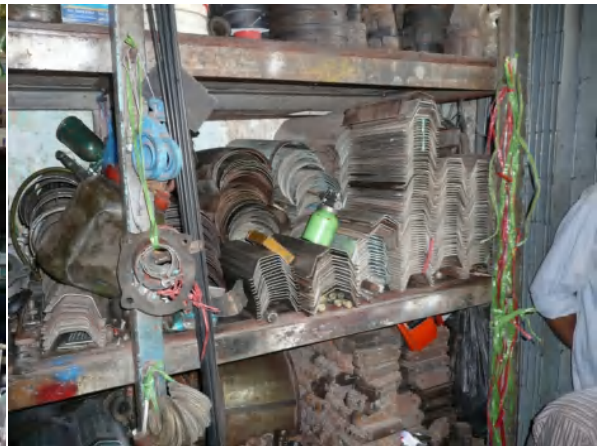
写真2：同農機販売店… 籾摺り機・精米機のスペアパーツ(ベトナム製/中国製のラバーロール、搗精金網、抵抗爪や攪拌ロール)も販売している
