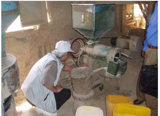
個人所有の精米所。精米機は中国製で効率が悪い(約55%)
