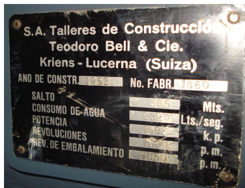
発電機の設置は1952年。水頭6.5m、水量2.82m 3 /sec、発電量1,487kw
